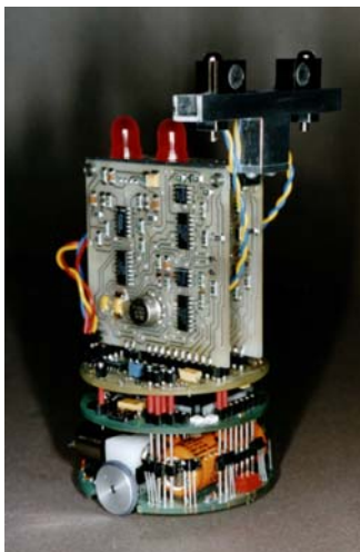
Khepera con “oídos” que simula un grillo hembra (Lund y col., 1997). Universidad de Edimburgo.
